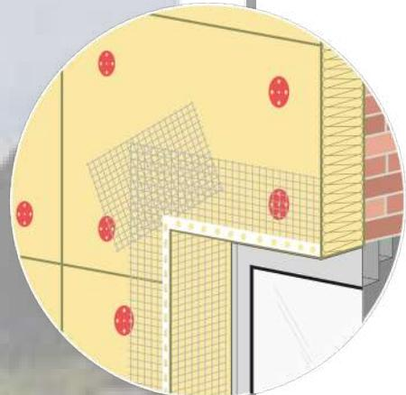
Каждый следующий ряд армированной сетки крепится внахлест (не менее 10 см). Эти слои утапливаются в клеевой смеси до ровной поверхности стены. Оставляем клеевой состав подсохнуть на несколько дней, это необходимо для следующих этапов монтажа гибкой керамики.
